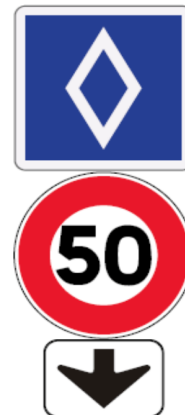
Exemple de signalisation de position implantée au-dessus de la voie réservée et couplée à une signalisation de vitesse maximale autorisée
