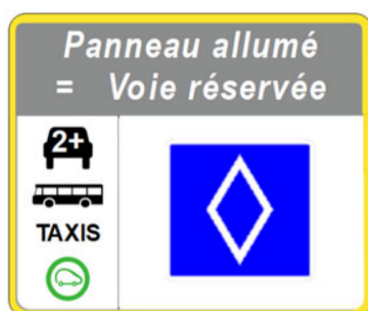
Option 1 Variante pour une signalisation dynamique en technique de matrice intégrale
